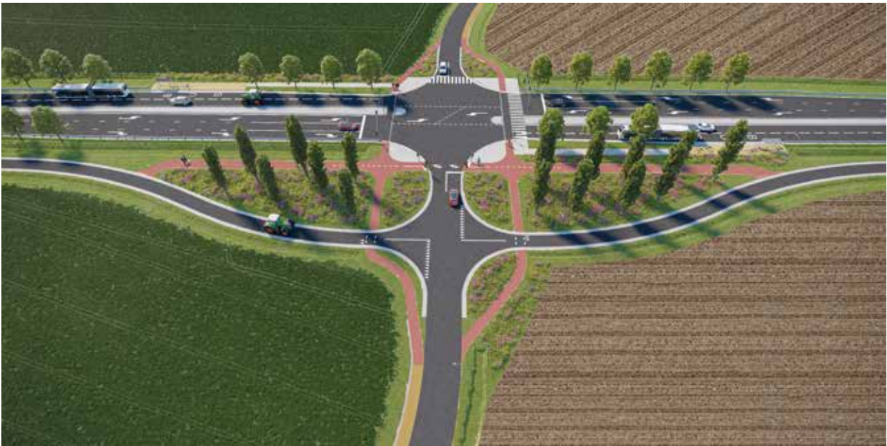
Het kruispunt Presendestraat/Landbouwersstraat na de werken. Onderaan zie je de ventweg die lokaal landbouwverkeer en fietsers scheidt van het doorgaand verkeer.
